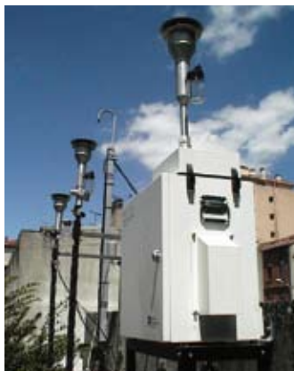
Station de surveillance des particules PM10 (particules de taille inférieure à 10 microns) et des particules PM2,5 (de diamètre inférieur à 2,5 microns) à la station Toulouse Berthelot
