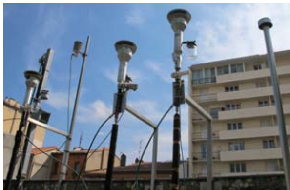
Têtes de prélèvement des analyseurs de particules inférieures à 10 microns à la station Toulouse-Berthelot
