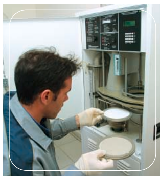
Remplacement de filtres
